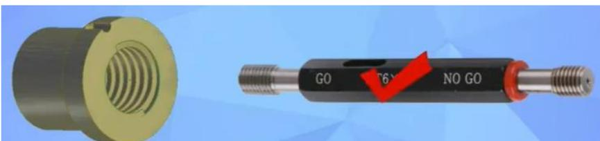
通规用来检查:直螺纹套筒丝扣通畅
